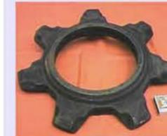
Литой венец приводной звезды СП-301 скребкового конвейера (сталь 40Х)
