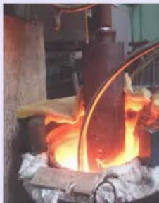
Процесс наплавки меди на сталь
