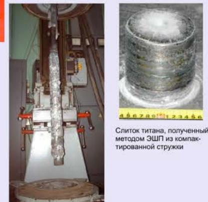
Слиток титана, полученный методом ЭШП из компактированной стружки
