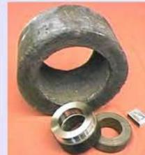
Отливки заготовок подшипников скольжения из бронзы БрА5Ж4
