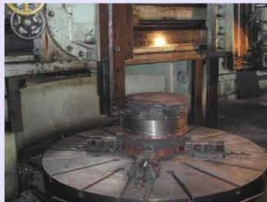
Биметаллический слиток (диаметр 700 мм, высота стальной части 500 мм, медной 400 мм)
