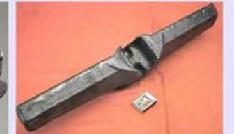
Литой скребок породопогрузочной машины типа 2ПНБ-2 (сталь 35ХГСА);
